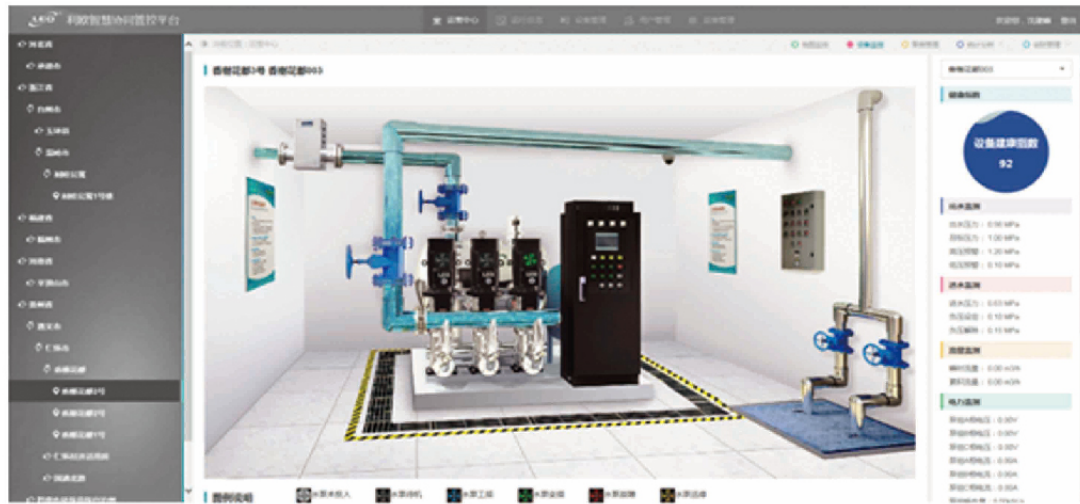
泵房数据、状态监测监测 (将设备的运行数据、以及水质、管网、门禁等状态信息进行实时监测)
