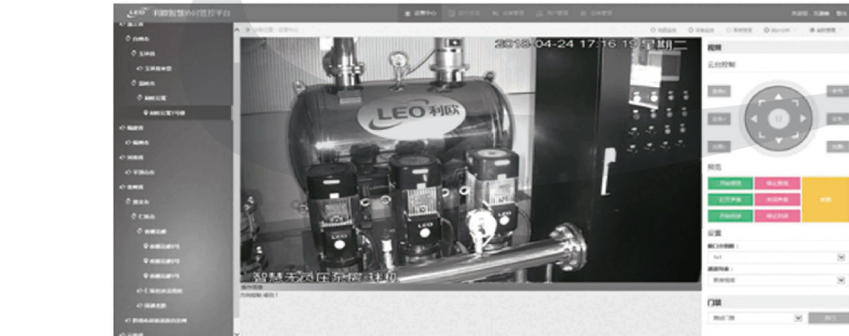
红外抓拍安防技术 (可以与门禁系统联合安防, 当有人进入泵房时, 通过红外感应, 联动泵房摄像头进行抓拍取证, 保障泵房安全)
